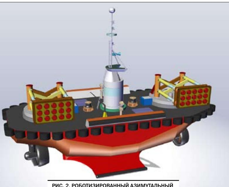
РИС. 2. РОБОТИЗИРОВАННЫЙ АЗИМУТАЛЬНЫЙ БУКСИР-АВТОМАТ (АБА)
